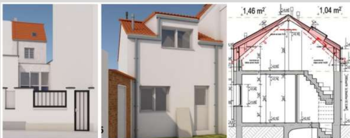
Axonométries projetées de la façade avant et d'une des façades de l'annexe – Annexe : Coupe CC projetée (extr. du dossier de demande)
