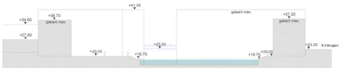
Afbeelding 7: Indicatief plan van de ligging van een dok op het Shell-blok (ARIES, 2017)
