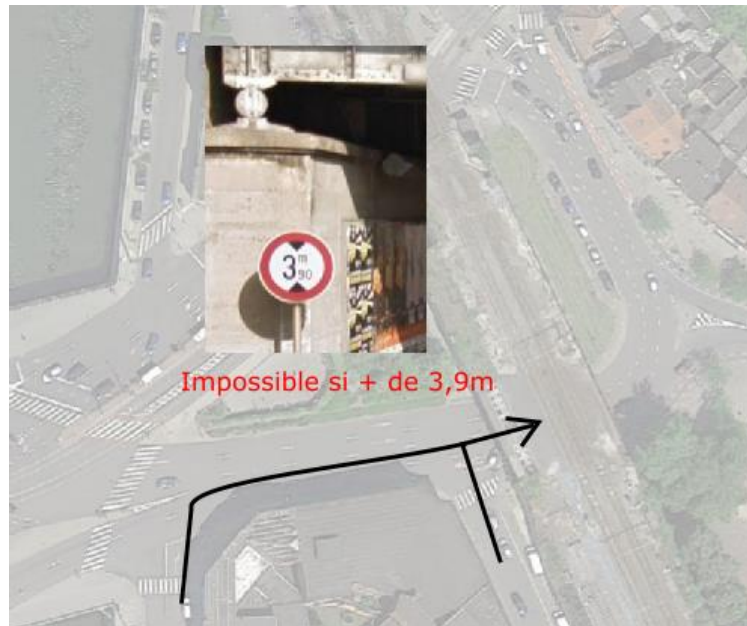
Figure 56 : Manoeuvres impossibles au carrefour Cureghem pour les véhicules dont la hauteur dépasse les 3,9 mètres (ARIES, 2015)
