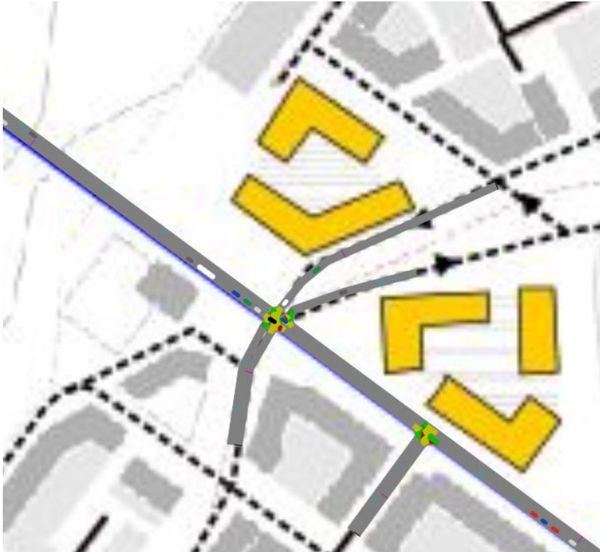
Figure 75 : Extrait de la microsimulation VISSIM montrant les remontées de files ponctuelles au carrefour projeté durant la période de pointe du matin (ARIES, 2015)
