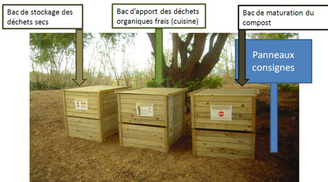
Figure 4 : Exemple d'un site de compostage collectif (Source : www.tco.re , 2015)
