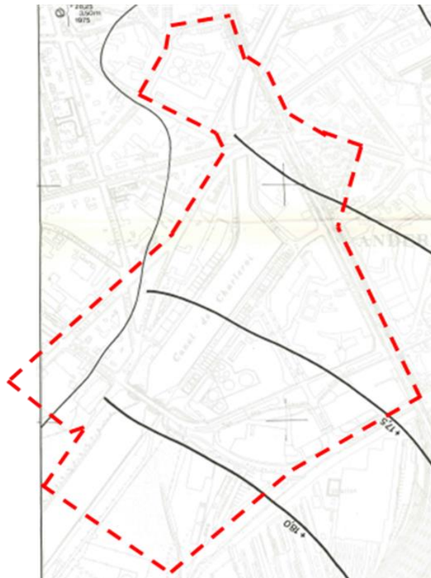
Figure 4: Cotes altimétriques de la nappe aquifère (adapté de la planche XI (hydrogéologie) de la carte géotechnique 31.3.7 Bruxelles)
